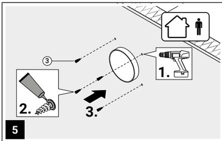
Die Löcher ( $\varnothing$  4 mm) an den markierten Positionen bohren. Anschließend Dichtkleber auf die Unterseite der Dübelteller geben und die Montagedübel einschrauben.
