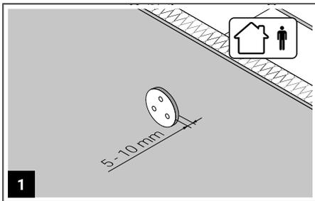
Das Montagerohr ist installiert und steht 5-10 mm über. Die Fassadenarbeiten sind abgeschlossen.
