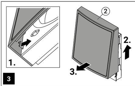
Die inneren seitlichen Rasthaken im Cover lösen und das Cover vom Rahmen abziehen.
