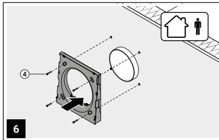
Den Rahmen mit Hilfe der Montageschrauben waagrecht an der Wand montieren.
