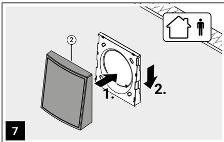
Das Cover auf dem Rahmen anbringen und soweit herunterschieben bis die Rasthaken eingerastet sind.
