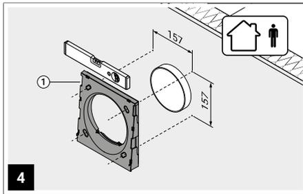
Den Rahmen waagrecht über dem Montagerohr positionieren und die vier Montagepunkte markieren.
